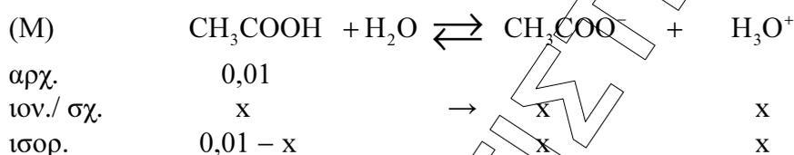
$$K_a = \frac{[\text{CH}_3\text{COO}^-][\text{H}_3\text{O}^+]}{[\text{CH}_3\text{COOH}]} \text{ ή } 10^{-5} = \frac{x^2}{0,01 - x} \quad (1)$$
